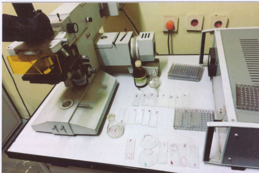
Рисунок 10. Подготовка препарата к исследованию под микроскопом. Накрывают препарат покровным стеклом. На препарат наносится нефлуоресцирующее иммерсионное масло.
