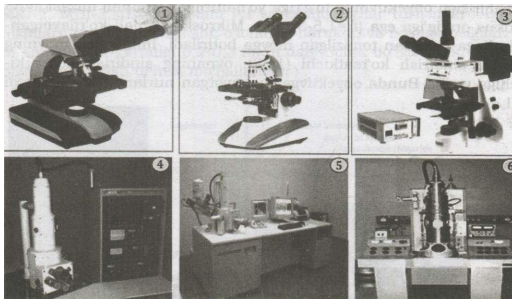
1.5-rasm. Mikrobiologik amaliyotda qollaniladigan mikroskoplar: 1,2-binokulyar mikroskoplar; 3-lyuminessent mikroskop; 4-lazerli konfakal mikroskop; 5-interferensiyalovchi kompyuterli mikroskop; 6-elektron mikroskop.
