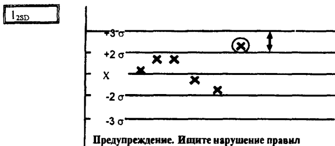
Рис 13. Правило "опасности" или сигнальный критерий: полученное значение больше, чем +2\sigma или -2\sigma . Если это происходит только на одном уровне в течение одного дня, то это можно рассматривать только как предупреждение.
