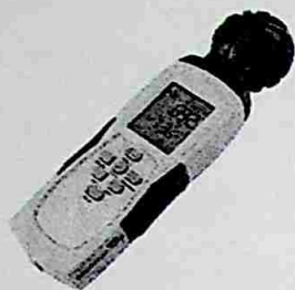
3.7.1-rasm. "Termo-gidro-CO 2 -metr" havo harorati, CO 2 va namlikni o'chovchi asbob
