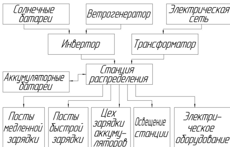
Рисунок 2. Схема системы энергоснабжения станций обслуживания электромобилей
