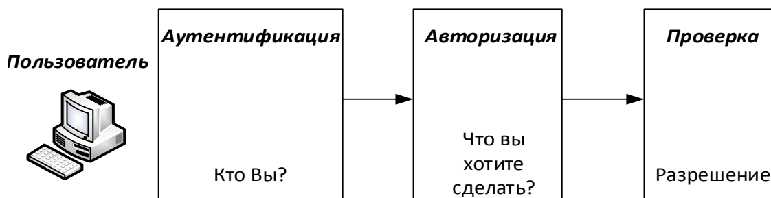
Рисунок 1. Принцип работы протокола Kerberos
