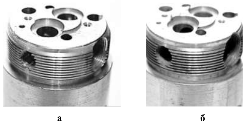
Рисунок 3 – Корпусная деталь из сплава АЛ 9 до (а) и после (б) удаления ликвидов и округления кромок на резьбовых отверстиях
