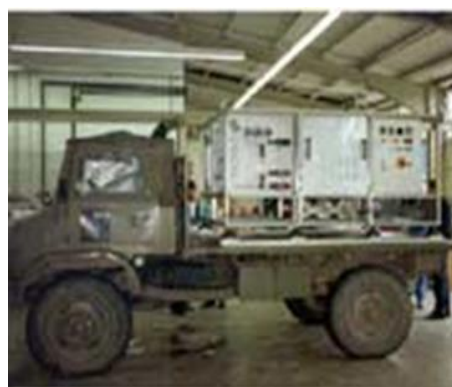
MAFS-3(takomillashtirilgan avtofiltrlash stansiyasi)
